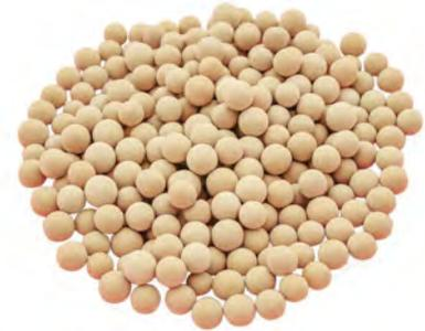
**El sistema de secado en línea TRANSEC** emplea tamices moleculares con el fin de extraer la humedad del aceite. Estos gránulos (no químicos) contienen muchos poros de 3 angstrom de diámetro que es el tamaño exacto para atrapar las moléculas de agua. De esa manera otros componentes tales como gases y moléculas con mayor o menor diámetro no son filtrados por estos tamices.
